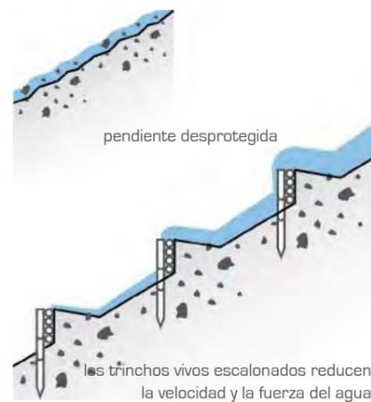
► Control de la erosión en quebradas con pendientes muy inclinadas
