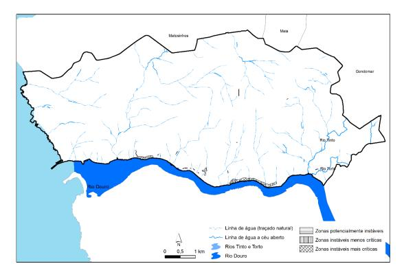
Figura 11 – Zonas de taludes ou escarpas, instáveis ou potencialmente instáveis, no concelho do Porto.
