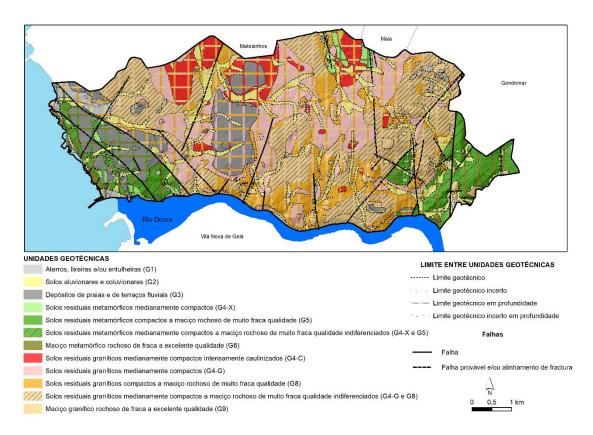
Figura 7 - Unidades Geotécnicas no concelho do Porto
